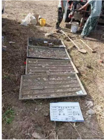
照片 1-6 DPP-100 钻机岩芯样品 照片 1-7 DPP-100 钻机岩芯样品 照片 1-8 标准贯入及动探试验 (孔号: ZK5; 深度: 0-20m) (孔号: ZK6; 深度: 0-20m) (ZK7)
