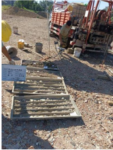
照片 1-6 DPP-100 钻机岩芯样品 照片 1-7 DPP-100 钻机岩芯样品 照片 1-8 标准贯入及动探试验 (孔号: ZK5; 深度: 0-20m) (孔号: ZK6; 深度: 0-20m) (ZK7)
