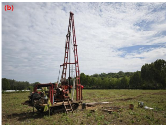
照片 1-11 施工设备 b: XY-200 钻机
